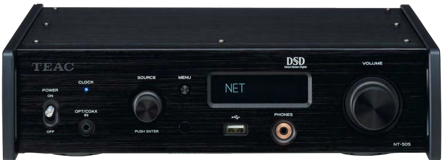
Auf der Front findet sich links ein optisch/koaxialer Digitaleingang, mittig der USB-Port für den Anschluss von Sticks und Festplatten und rechts der Kopfhörerausgang. Durch das Menü navigiert man mit dem linken Drehrad mit Druckfunktion.
