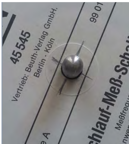
Auf 8,5 mm geweitetes Loch der DIN-Schallplatte mit Zentrierungsmarkierung.
