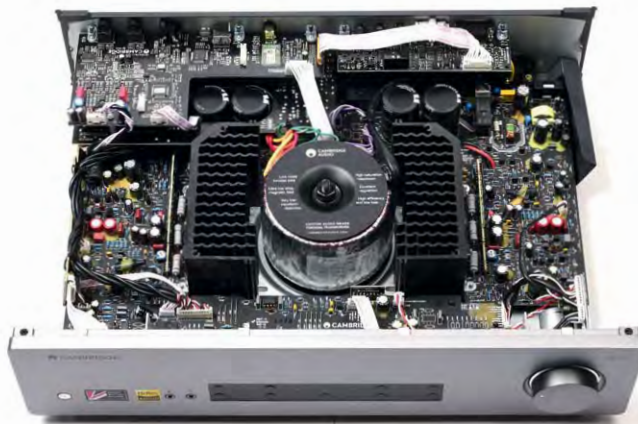
Wirklich audiophil: Die Signalwege sind kurz, in der Mitte bietet ein großer Ringkerntrafo die nötige Spannung auf.
