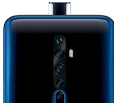
Bei Selfies sorgen farbige LEDs für einen Countdown. Sensoren erkennen, wenn das Smartphone fällt, und fahren die Pop-up-Kamera sofort wieder ein.
