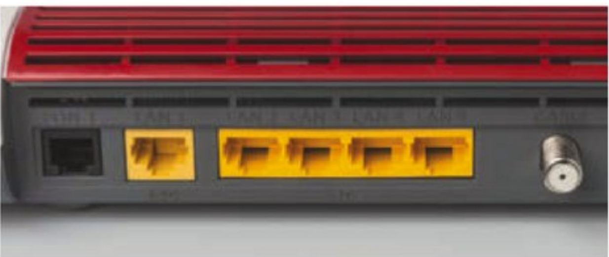
Das Modell 6660 ist die erste Fritzbox mit beschleunigtem Ethernet: Ihr LAN-Port 1, die abgesetzte gelbe Buchse, transportiert bis zu 2,5 GBit/s.
