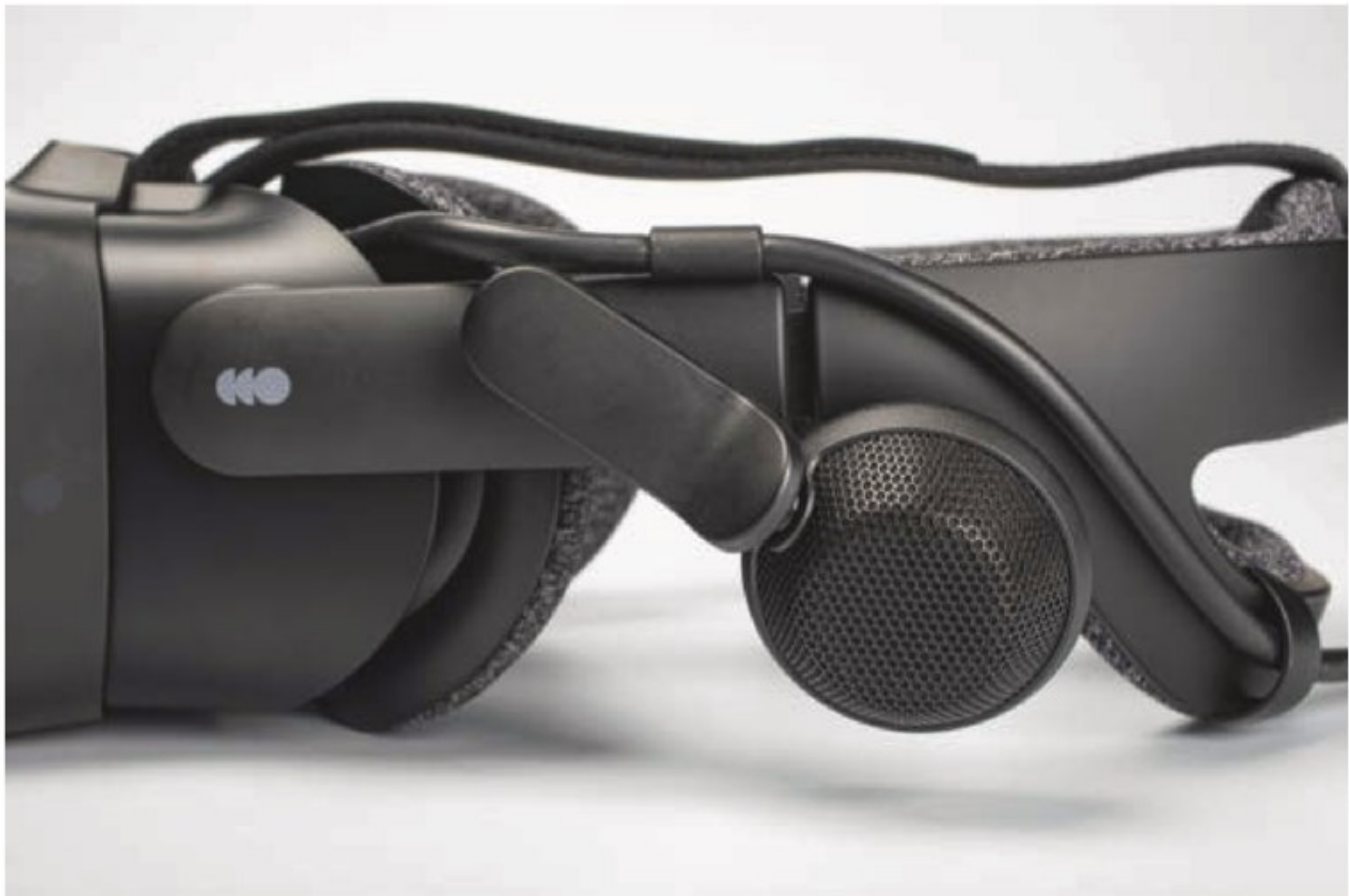
Die Index hat Nahfeld-Lautsprecher eingebaut, die nicht direkt auf dem Ohr aufliegen.
