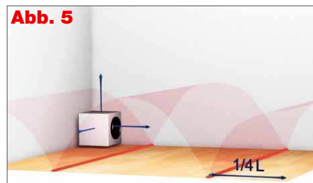
Abb. 5 Steht der Subwoofer direkt im Maximum einer stehenden Welle, wird diese stark angeregt. Der Schalldruckverlauf dieser Frequenz im Raum wird durch die rote Fläche symbolisiert
