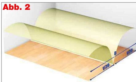
Abb. 2 Auch in der Breite (und Raumhöhe) entstehen stehende Wellen, deren Frequenzen von der Raumbreite abhängen. Auch hier existieren „laute“ und „leise“ Stellen, allerdings bei anderen Frequenzen, sofern der Raum nicht quadratisch ist
