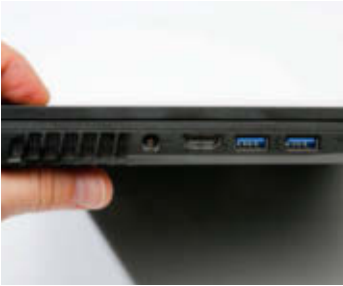
MSI-Anschlüsse links: Strom, HDMI und zweimal USB 3.1 Typ A.
