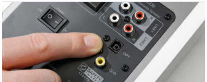
An der Rückseite der Edifier findet sich unter anderem ein optischer Digitaleingang.
