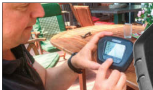
Das Display lässt sich vom Ventil lösen – praktisch fürs Einstellen der Bewässerungszeiten.
