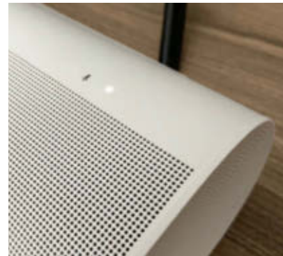
Eine LED signalisiert, dass die Mikrofone auf das Schlüsselwort „Alexa“ oder „OK, Google“ hören.
