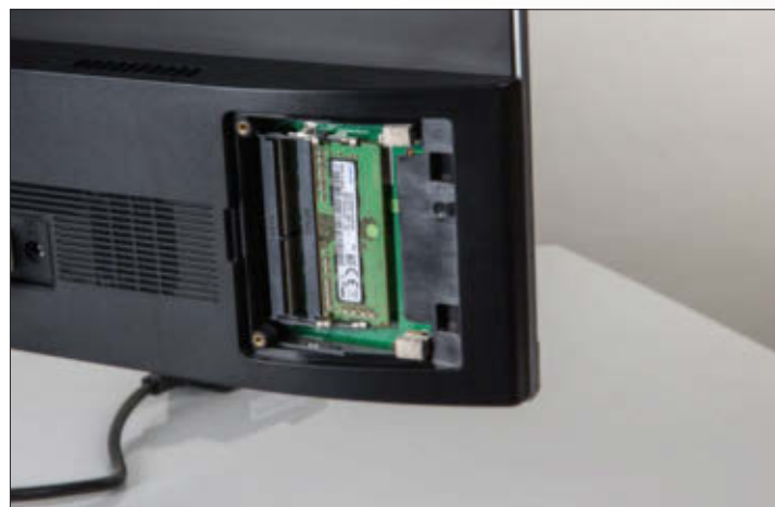
Klasse: An der linken Rückseite befindet sich noch eine Wartungsklappe. Dahinter sitzt der Arbeitsspeicher, der sich so problemlos erweitern lässt.
