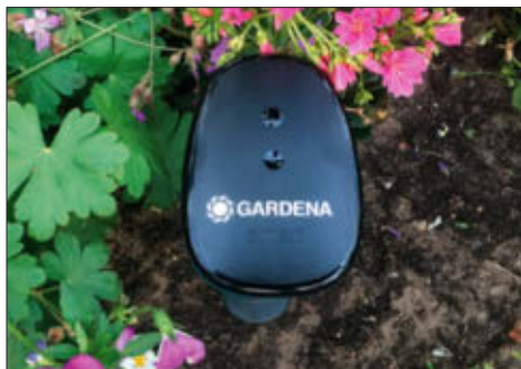
Der Gardena-Sensor ermittelt die Bodenfeuchte. Water Control passt bei Trockenheit aber nicht automatisch die Bewässerung an.
