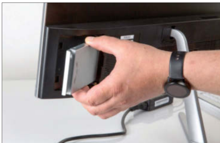
Da geht noch mehr: Nutzer können beim Wortmann eine zusätzliche 2,5-Zoll-SSD oder -Festplatte einbauen. Der Einschub befindet sich rechts an der Rückseite.
