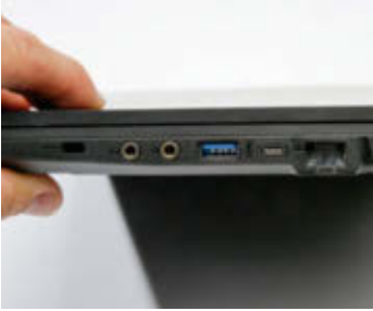
MSI-Anschlüsse rechts: zweimal Ton, USB 3.1 Typ A, USB-C und LAN.
