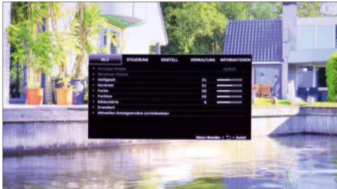
Liegt HDR-Inhalt an der HDMI-Buchse, schaltet der Beamer automatisch um, einige Bildeinstellungen kann man nun nicht mehr beeinflussen
