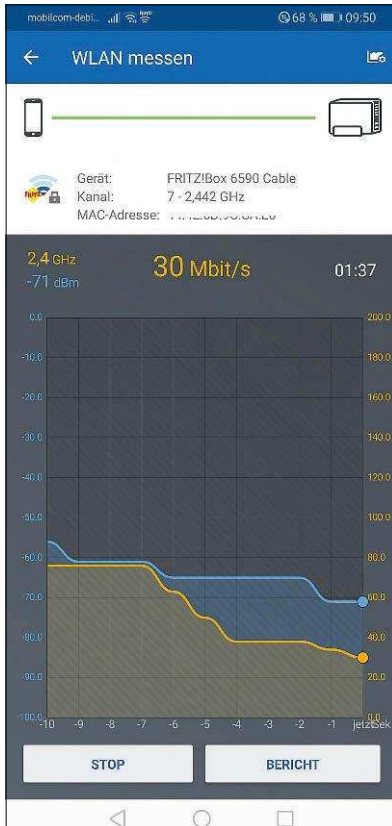
WLAN-Abbruch droht: Die FritzApp WLAN zeigt das nahende Funkloch, die Datenrate sinkt
