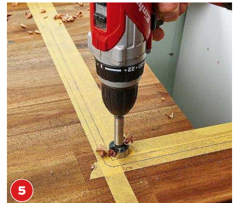
5 Die neu angezeichneten vier Ecken mit einem 25-mm-Forstnerbohrer ausbohren. So spart man sich das Kurvensägen.
